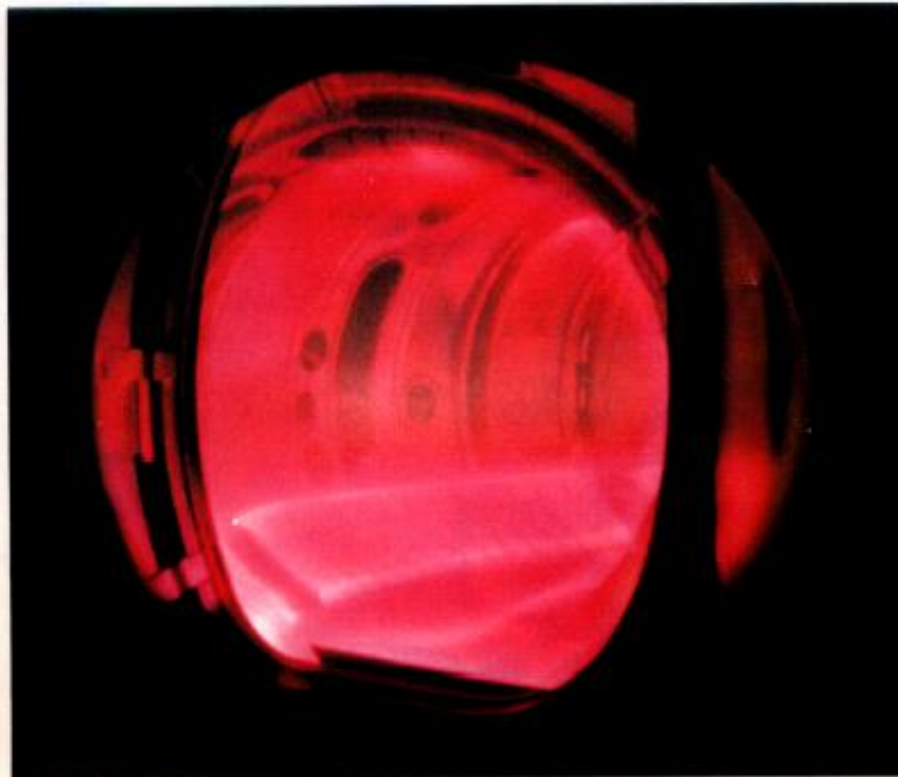
TEXTORプラズマとALT-II トロイダルポンプリミター (接線方向の窓より撮影) 詳細はP1参照
